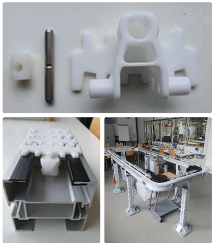
Bild 2. Einzelkomponenten (links oben) und montierte Förderkette auf Gleitschienen (links unten) sowie komplette Förderanlage im Technikum Technische Systeme in der Logistik, Hochschule Darmstadt (Mitte). Bildung der Systemgrenzen (rechts). Quelle: Prof. Dr.-Ing. Karsten Faust; Grafik: © Hanser
